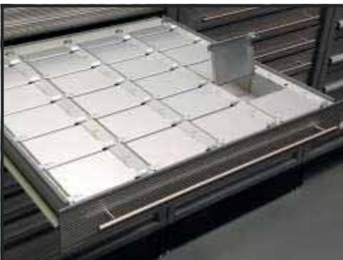
Sollte höchste Sicherheit bei der Ausgabe eine zentrale Rolle spielen, so lassen sich alle Schubladen auch in „Hochsicherheitszellen“ für Werkzeuge jeder Art einteilen. Hierbei werden Metallklappen eingesetzt, die nach dem gleichen Prinzip, wie bei den Schubladen, elektromechanisch verriegelt werden. Unterschiedliche Klappen-Größen sind lieferbar, eine Anpassung an vorhandenes Werkzeug ist problemlos möglich.
