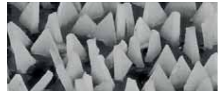
Optimale Ausrichtung des VICTOGRAIN-Schleifkorns
