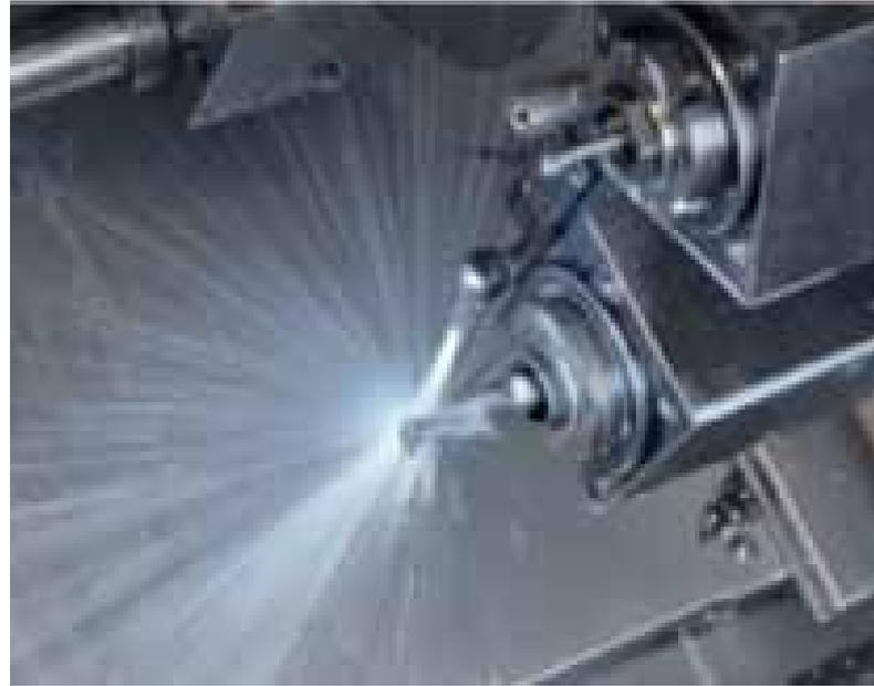
Der groß dimensionierte Durchlass sorgt für einen starken und gut zu kontrollierenden Kühlmittelstrahl. Die Richtungseinstellung erfolgt von Hand. Einfach in die gewünschte Richtung einstellen und die Überwurfmutter festziehen. Dank dem großen Einstellbereich ist eine Einstellung mit einem Winkel von bis zu 45° in jeder Richtung möglich.
