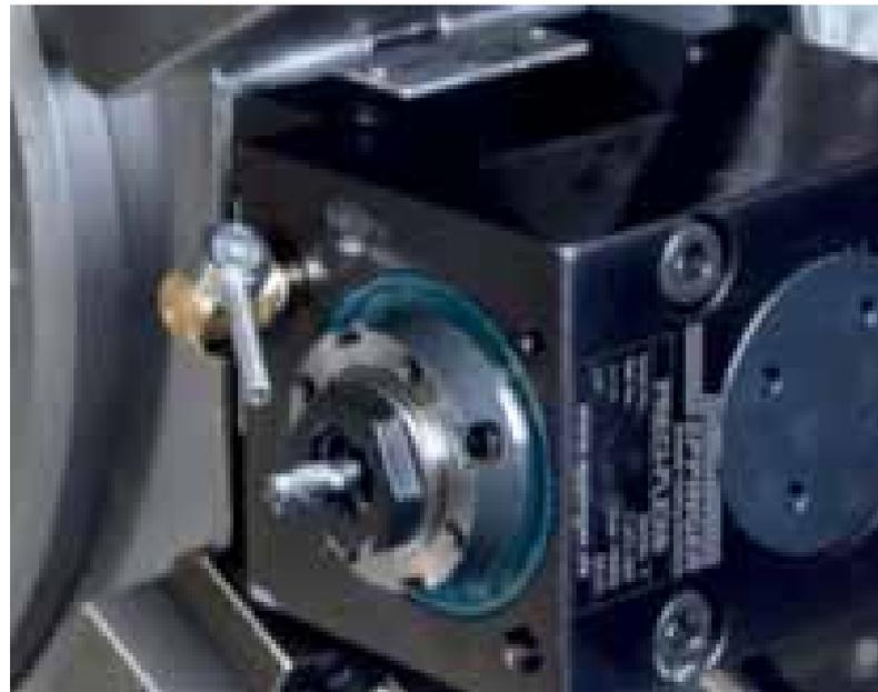
Der Einsatzort für die RingKD findet sich hauptsächlich in angetriebenen Werkzeughaltern deutscher, europäischer und asiatischer Hersteller. Mit einer optional erhältlichen Verlängerung kann die Düse in eine höhere Position gebracht werden.
