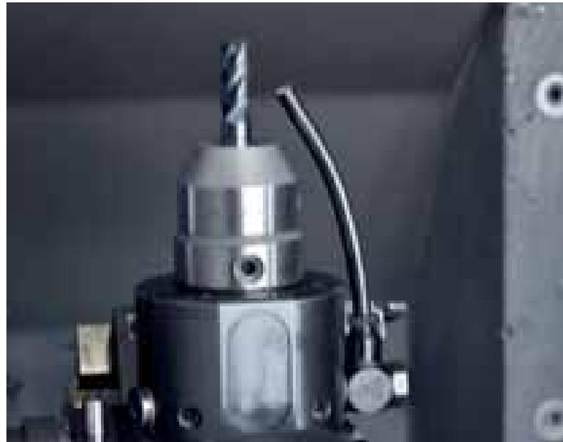
Wie die SmartKD ist die EdgeKD mit einem flexiblen Smartrohr ausgerüstet wodurch eine einfache Justierung des Kühlmittelstrahls gewährleistet ist. Trotz der flexiblen Struktur des Rohres bleibt der Kühlmittelstrahl in der Position wo Sie ihn haben wollen. Das Smartrohr ist einfach austauschbar und separat erhältlich.
