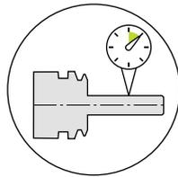
Rundlaufgenauigkeit ≤ 10 µm bei 3xD.
