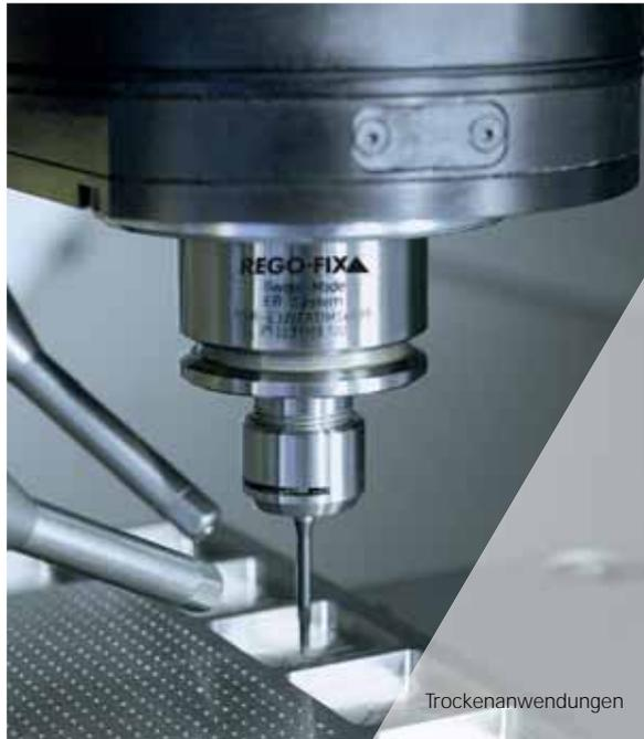
Trockenbearbeitung wird für bestimmte Bearbeitungstechniken und Werkstoffe verwendet, beispielsweise Kohle- und Glasfaser, hochfeste Kunststoffe und Holz.
