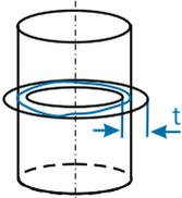
**Rundheit** Die Toleranzzone wird begrenzt durch zwei konzentrische Kreise vom Abstand  $t$ . Die Umfangslinie des tolerierten Zylinders muss in jeder beliebigen Radialschnittebene innerhalb eines Kreistrings der Zonenbreite  $t$  liegen.
