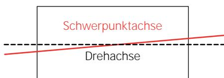
Um eine dynamische Unwucht zu reduzieren, wird auf zwei Ebenen Gewicht angebracht, entfernt oder verschoben.
