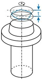
**Planlauf** Die Toleranzzone wird in jedem beliebigen radialen Abstand von zwei Kreisen im Abstand  $t$  begrenzt. Die Kreise liegen in einem Zylinder, dessen Achse mit der Bezugsachse übereinstimmt. Der Durchmesser des Zylinders kann jeden Wert des Durchmessers der Planfläche annehmen.
