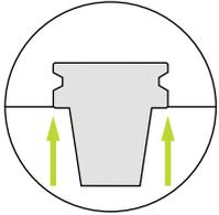
Höhere Steifigkeit durch Kegelanlage (AT1) und Plananlage.
