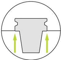
Höhere Steifigkeit durch Kegelanlage (AT1) und Plananlage.
