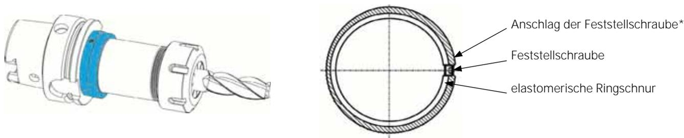
*\*Der Anschlag der Feststellschraube verhindert ein Herausschleudern, falls sich die Feststellschraube löst (z.B. durch Vibrationen) und diese rausgeschleudert wird, was bei hohen Drehzahlen und den daraus resultierenden Fliehkräften zu schweren Verletzungen und Maschinenschäden führen kann.*
