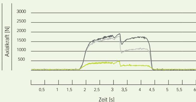
**Zusammenfassung** Die Axialkräfte nehmen mit steigender Drehzahl zu. Mit einer starren Werkzeugaufnahme sind die auftretenden Kräfte beim Gewindeformen erheblich höher als mit dem powRgrip® Softsynchro® Gewindeschneidfutter. Somit ist eine Nutzung der Synchronspindel bei der Gewindeherstellung optimal möglich, bei bestmöglicher Standzeit und Gewindeoberflächenqualität.
