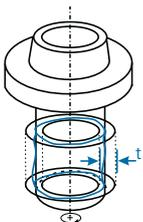
**Gesamtrundlauf** Die Toleranzzone wird begrenzt durch zwei koaxiale Zylinder vom Abstand  $t$ , deren Achsen mit der Bezugsachse übereinstimmen. Bei mehrmaliger Drehung um die Bezugsachse und axialer Verschiebung des Messwertaufnehmers müssen alle Punkte des tolerierten Elements innerhalb der Toleranzzone liegen.
