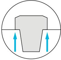
Höhere Steifigkeit durch Kegelanlage (AT1) und Plananlage.
