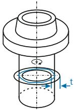
**Rundlauf** Die Toleranzzone wird in jeder beliebigen Radialschnittebene senkrecht zur Oberfläche begrenzt durch zwei konzentrische Kreise vom Abstand  $t$ , deren gemeinsamer Mittelpunkt auf der Bezugsachse liegt. Die Rundlauf-toleranz gilt allgemein für eine vollständige Umdrehung des tolerierten Elements um die Bezugsachse.
