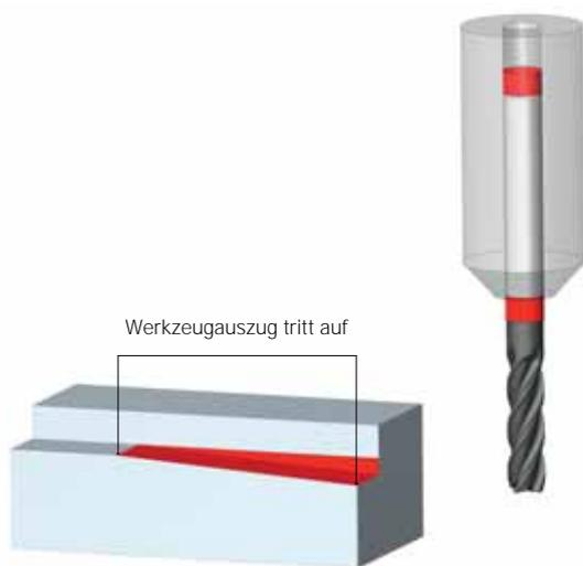
Längenveränderungen können zu einer Beschädigung des Werkstücks führen.
