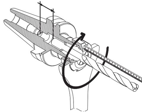
Werkzeuglänge mit Zwischenraum zur Anschlagschraube einstellen, dann Werkzeug spannen.
