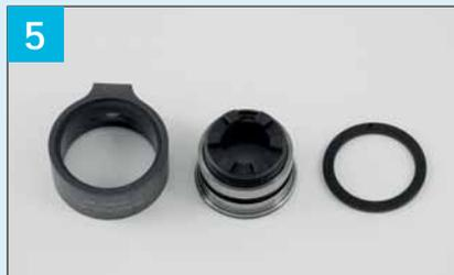
5 Alle Teile mit Industriereiniger reinigen.
