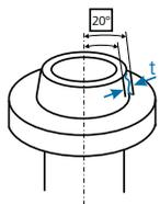
**Neigung** Die Toleranzzone wird begrenzt durch zwei im Nennwinkel zur Bezugsachse liegenden parallelen Ebenen vom Abstand  $t$ .
