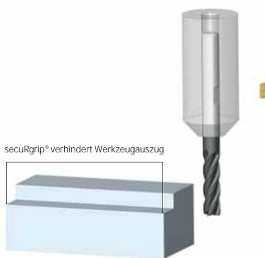
Werkstückschäden ausgeschlossen dank REGO-FIX secuRgrip®.
