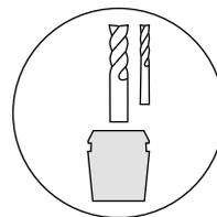
Das breite ER-Produktsortiment spannt alle Durchmesser von 0,2 mm bis 36 mm.
