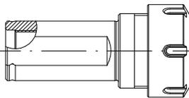
**CYL/ER NC** Die Spannzangenhalter mit zylindrischem Schaft und Fläche sind speziell für CNC-Drehmaschinen geeignet, können aber auch auf konventionellen Drehmaschinen eingesetzt werden.
