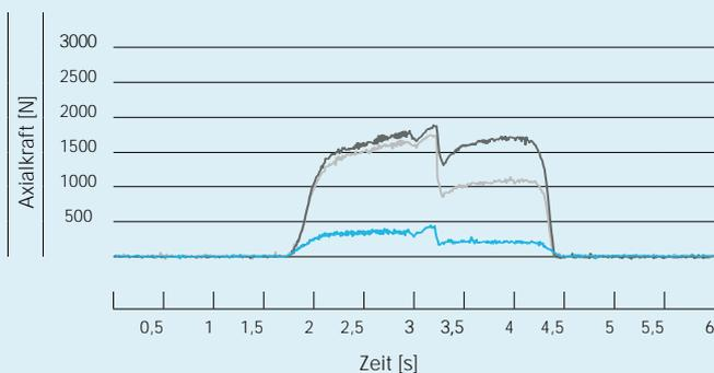
**Zusammenfassung** Die Axialkräfte nehmen mit steigender Drehzahl zu. Mit einer starren Werkzeugaufnahme sind die auftretenden Kräfte beim Gewindeformen erheblich höher als mit dem REGO-FIX Softsynchro® Gewindeschneidfutter. Somit ist eine Nutzung der Synchronspindel bei der Gewindeherstellung optimal möglich, bei bestmöglicher Standzeit und Gewindeoberflächenqualität.
