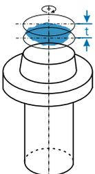
**Gesamtplanlauf** Die Toleranzzone wird begrenzt von zwei parallelen Ebenen vom Abstand  $t$ , die senkrecht zur Bezugs-(Rotations-)achse stehen. Bei mehrmaliger Drehung um die Bezugsachse und radialer Verschiebung des Messwertaufnehmers müssen alle Punkte der Oberfläche der tolerierten Planfläche innerhalb der Toleranzzone liegen.
