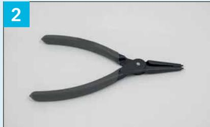
2 Mit Zange Sicherungsring demontieren.
