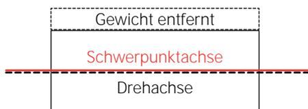
**Dynamische Unwucht** Eine dynamische Unwucht tritt erst im Betrieb auf. Sie äussert sich in einem Unwuchtmoment auf der Rotationsachse und ruft an ihren Enden um 180° verschobene, kreisförmige Schwingungen hervor. Der Schwerpunkt des rotierenden Körpers bleibt in Ruhelage, während die Achse wegen der entgegengesetzten Kreisbewegungen taumelt.
