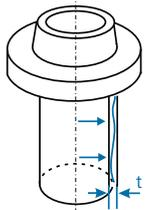
**Parallelität** Die Toleranzzone, innerhalb der die Mantellinien des tolerierten Zylinders liegen müssen, wird begrenzt durch zwei parallele Geraden vom Abstand  $t$ , die parallel zur Bezugsfläche laufen.
