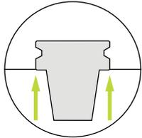
Höhere Steifigkeit durch Kegelanlage (AT1) und Plananlage.
