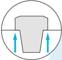
Höhere Steifigkeit durch Kegeelanlage (AT1) und Plananlage.
