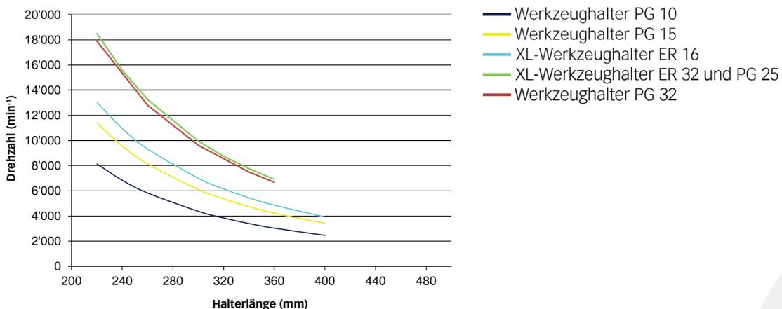
Berechnung der maximalen Drehzahl einer Welle mit fliegender Lagerung. Berechnete Werte ohne Berücksichtigung der:
