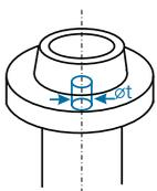
**Koaxialität** Die Toleranzzone wird begrenzt durch einen Zylinder vom Durchmesser  $t$ , dessen Achse mit der Bezugsachse übereinstimmt. Die Ist-Achse des tolerierten Elements muss innerhalb der Toleranzzone liegen.
