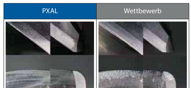
Schneiden nach 300m Fräsweg
