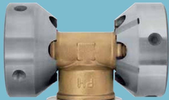
Schneideisen mit eingelöteten HM-Schneidstegen Thread cutting die with brazed carbide cutting edges
