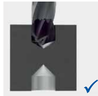
Durchbruch bei Gegenbohrung; v_f = -50\%
