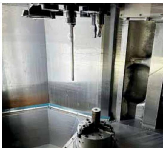
Bei einem neuen Bauteil, einer Zugstange aus Vergütungsstahl, musste ALMU eine 375 Millimeter tiefe Bohrung einbringen.
