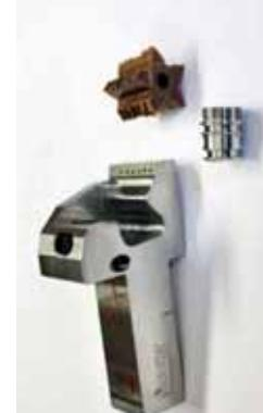
*Mit dem maßgeschneiderten PENTA 27-Schneidein satz von ISCAR fertigt Apelt eine komplexe Hülse aus Edelstahl und vor allem prozesssicher.*
