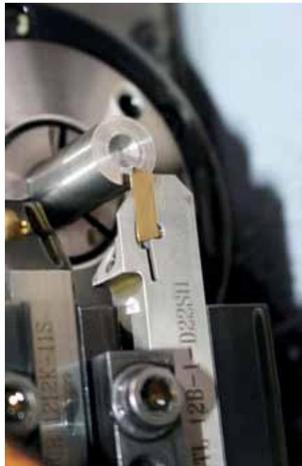
Bei der Fertigung von Buchsen aus Edelstahl setzt Martin Präzisionstechnik seit Anfang des Jahres auf die nur einen Millimeter breiten Schneideeinheiten aus ISCARs DO-GRIP-Linie.
