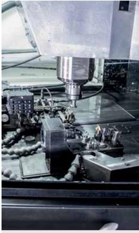
Mit dem Produktionsdreihaupten von DMG Mori ist ein automatischer und wirtschaftlicher Fertigungsprozess mit sechs Linearmotoren und zwei C-Achsen möglich. Trotz benötigter Platzverhältnisse dauert der Plattenwechsel des SUMOCHAM lediglich 10 Sekunden.
