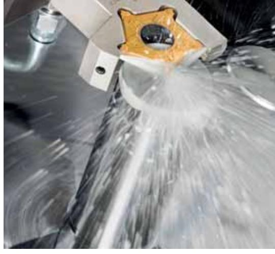
Das fünfschneidige Abstechwerkzeug PENTA-IQ-GRIP ermöglicht das Abstechen von Werkstücken mit einem Durchmesser von bis zu 40 Millimetern.
