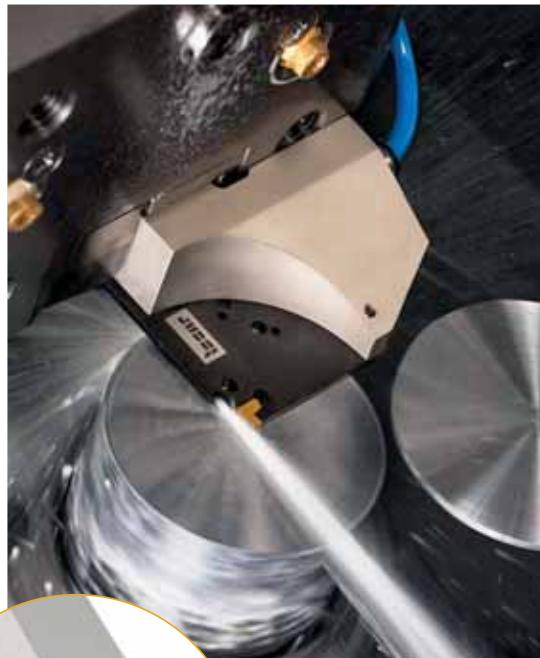
Zum Abstechen auf der X-Achse kann der Y-Achse bieten ISCAR die neuen Werkzeuge der LOGIQ-F-GRIP-Linie mit einem quadratischen Schniedenträger und vier Plattenstützen.
