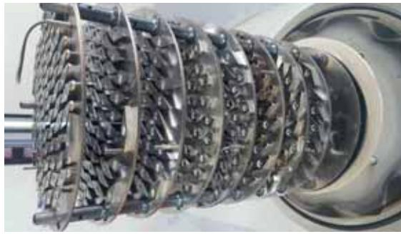
Die mit Lotpaste und Flussmittel versehenen Komponenten werden beim Hochvakuum-Löten prozesssicher verbunden.
