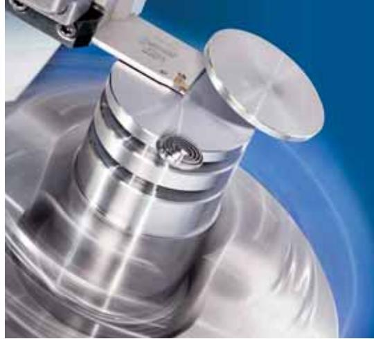
Dank der stabilen Klemmung kann der Schniedeinsatz des TANG-GRIPs den auf das Werkzeug wirkenden Schnittkräften beim Abstechen entgegenwirken.
