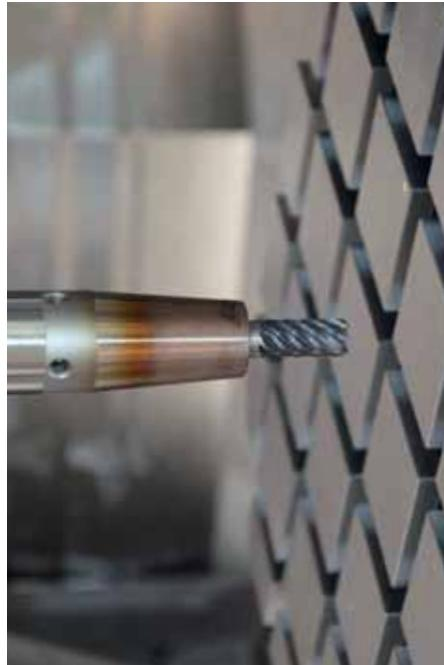
Der VHM-Torfräser Z7 von ISCAR bringt die Nuten in gleichbleibender hoher Qualität in gehärteten Stahl ein.
