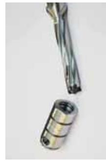
Der Wechselskopfbohrer LOGIQ3CHAM bringt bei DEMMELER die Kernbohrungen prozesssicher schnell an und mit hoher Maßhaltung gewechselt. Eine Nachjustierung ist nicht erforderlich.
