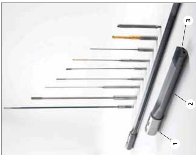
Während gelöste Einlippentieflochbohrer aus drei Komponenten bestehen – Einspannhülse [1], Profilrohr aus Stahl [2] und Hartmetallbohrkopf [3] – werden beim Vollhartmetall-Einlippenbohrer nur zwei Komponenten verwendet, nämlich Einspannhülse [1] und VHM-Bohrschafft [2].
