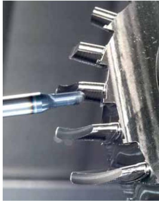
Für sehr gute Ergebnisse beim trochoidalen Fräsen eines Blisk-Schaufelblatts kann der mehrschneidige VHM-Schaftfräser in einem Schrumpfzylinder gespannt werden.
