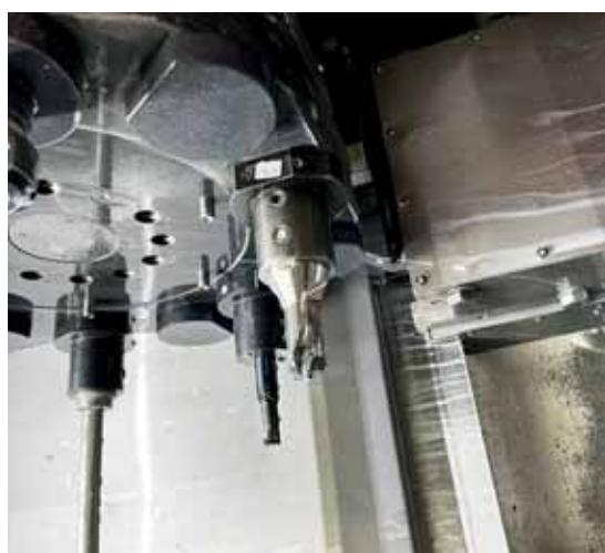
Die Pilotbohrung brachte ISCAR mit dem Wechselkopfbohrer SUMOCHAM-Serie ein.
