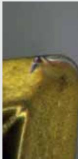
Die Dreh-Wendeschneideplatte CCGT 09T304 eignet sich gut für das Schäppen von Ecobrass.
