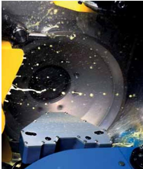
Beim Schleifen wird die Scheidekante geformt und die Negativphase eingebracht.
