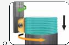
Linkes Außengewinde, konventionelles Fräsen
