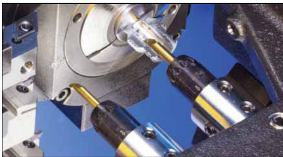
Vollhartmetallwerkzeuge zum Innengewindedrehen im Mindestdurchmesser 2,4 mm (0.094 inch)
