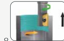
Rechtes Innengewinde, Gleichlaufräsen
