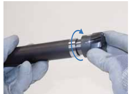
3. Den Wechselkopf im Uhrzeigersinn handfest in den Wechselkopfhalter eindrehen. Anschließend den Wechselkopfhalter samt Werkzeug in den Maschinenhalter einspannen.
