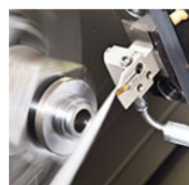
JET-HP-LINE Hochdruckkühlung bei Abstechwerkzeugen
