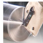
JET-CUT Abstech- Schneideinsatz mit direkter Jet-Kühlung
