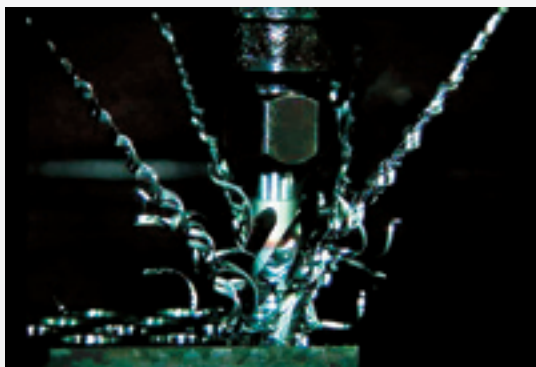
Konventioneller Gewindebohrer · Conventional tap · Taraud conventionnel · Maschiatura convenzionale
